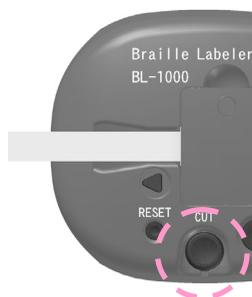
テープ排出口から印字したテープを取り除くと、ブザー音の間隔が10秒に開きます。
