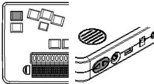
BM スマートを起動した時、ボリュームボタンは、メインボリュームを調節する状態になっています。この状態でアップ/ダウンボタンを押すと、スピーカーやヘッドフォンから出る音のボリュームを調節できます。
